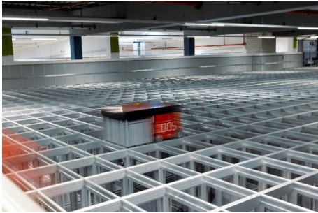
BU: Zu den Highlights des Distributionszentrums gehört ein sogenannter AutoStore für Kleingebinde mit 12.000 Boxen. © DAW SE
