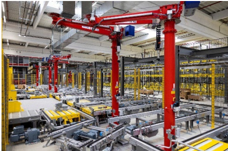
BU: Kommissionier-Arbeitsplätze nach dem Ware-zum-Mann-Prinzip. Hebehilfen und eine höhenverstellbare Fördertechnik führen zu einem optimalen und ergonomischen Arbeiten © DAW SE
