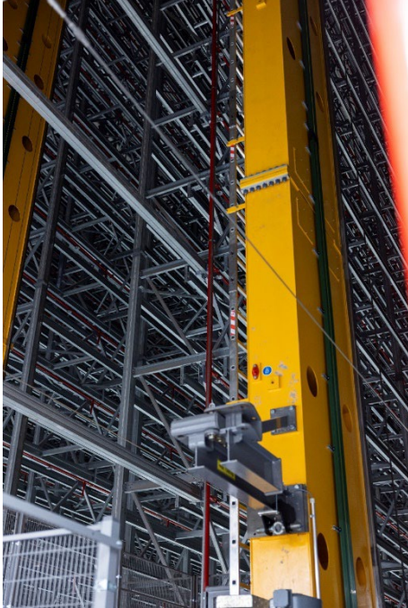
BU: Regalbediengerät zum Ein- und Auslagern der Paletten © DAW SE
